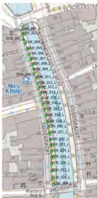
Figuur 2.2; locaties prisma's aan werfmuur rak 1 west
